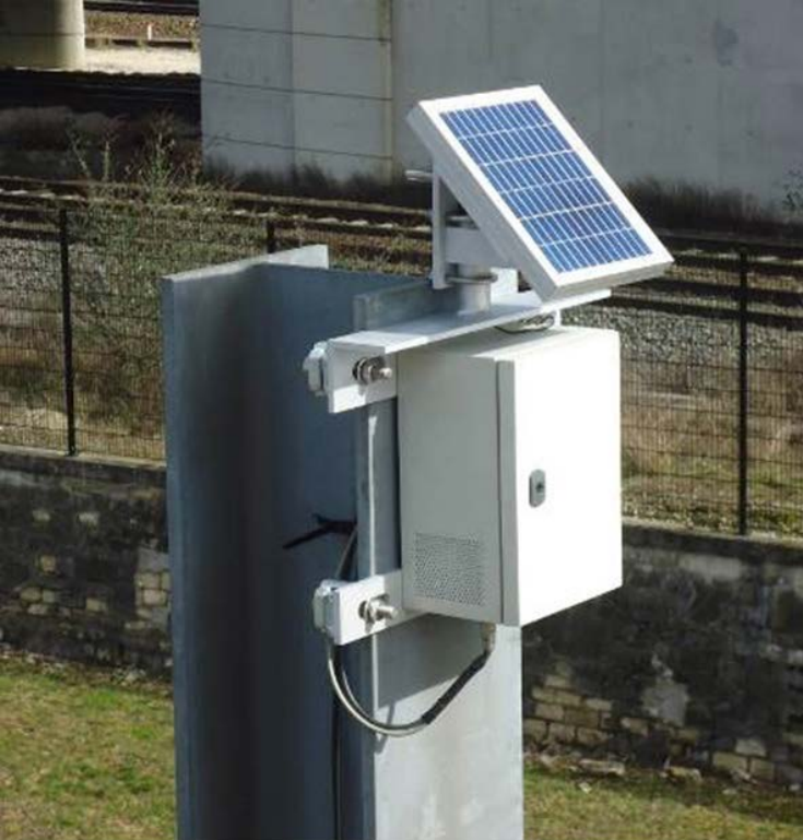
Moduł zasilająco-komunikacyjny gazowego urządzenia naprężającego
