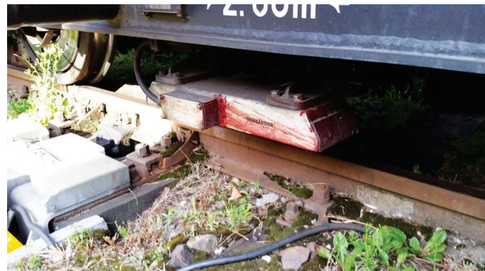
Fot. 1. Szczątki biologiczne na elementach podwozia taboru kolejowego. Fot. Koleje Wielkopolskie
