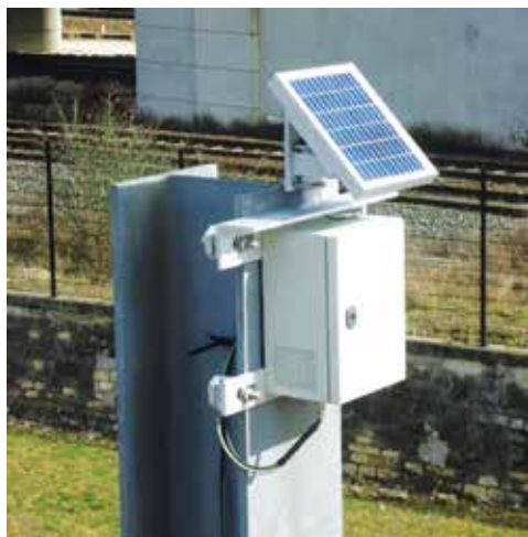
Fot. 5. Moduł zasilająco-komunikacyjny gazowego urządzenia naprężającego
